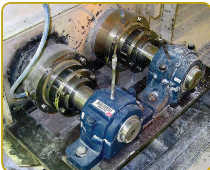
無機物微粒子を処理する2軸型パドルミキサーに取り付けた127mm用分割型 OFSタイプ1シール
