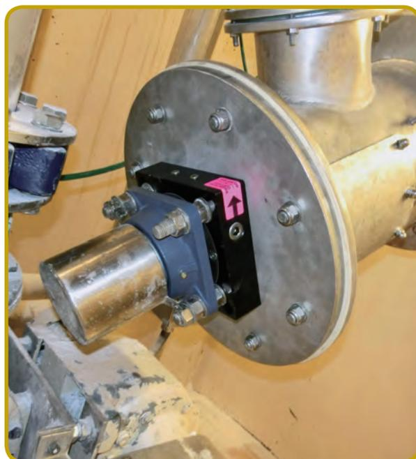
傾斜スクリーコンベアの40 mmシャフトに取り付けられたHCZ1W4A157シール
