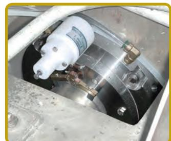
図2 ATEX EN 94/9の防爆指令に準拠したMECO AHタイプ2S
