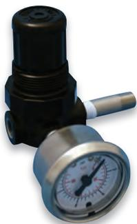
MECOシールで標準的に必要なエアパージをするために、弊社R-384のエア調節キットには、30-300kPaGの圧力範囲で調節可能な1/8" NPTポートの付いたエアレギュレーターが入っており、空気や窒素などの圧縮ガスに対して使用できます。加えて、シール室圧力のモニター用のプラスチックレンズの付いた100 kPaの圧力計と1/8" NPT のSUS316ニップルも付属しています。
