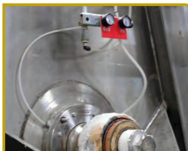
化学製品の攪拌機の165mmシャフトに取り付けたAHタイプ2APシール
