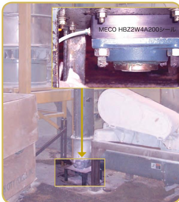
垂直の砂糖用スクリーコンベアの底面に取り付けられた
