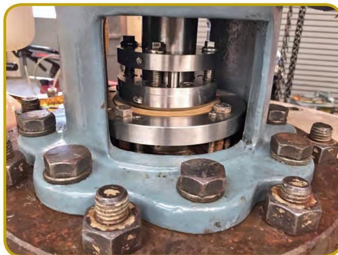
プラスチックレジンとそこから発生するVOCを有する縦型の攪拌機に取り付けられた50mmサイズの OFSタイプ1シール
